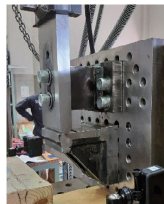
図-2 実験実施状況（セットボルト試験体）
