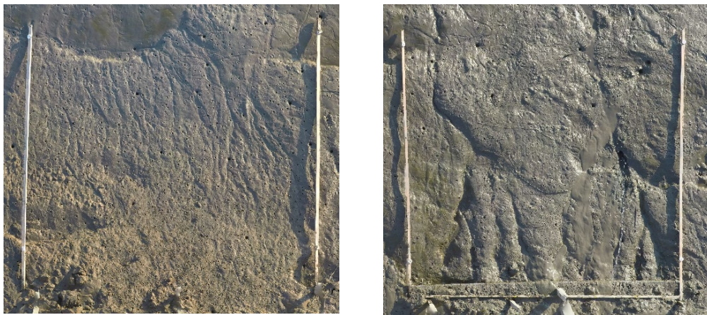
図 2 調査開始後 35 日目の非散水域と散水域におけるガタ土面の時系列変化（2022 年 10 月 14 日，左：非散水域，右：散水域）
