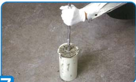
7 通常の突き固めを行います
