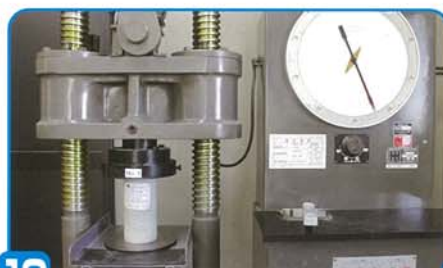
10 圧縮強度試験
