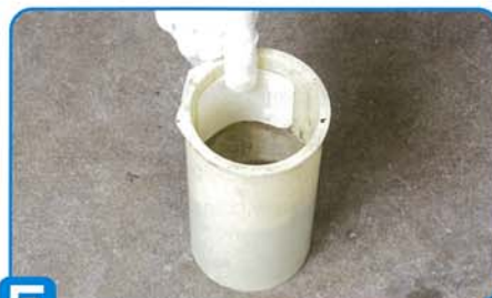
5 記入面が型枠の内側に接するように、型枠の上縁 から1～3cmの位置にシールを合わせ指で固定し、コン クリートを流し込みます
