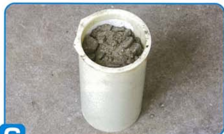
6 コンクリートでシールが固定されたら指をはず し、最後までコンクリートを流し込みます
