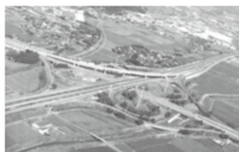
鳥栖ジャンクション 日本初、4つ葉クローバー 九州の高速道十文字にクロス
